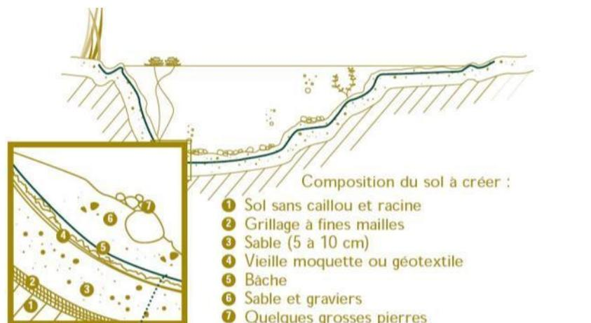
Figure 8 : Exemple de coupe pour une mare bâchée.
